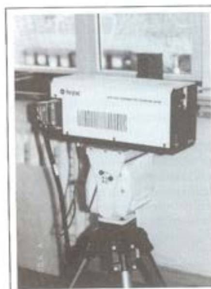
Bild 7: Laservibrometer PSV 300 F montiert auf Stativ mit motorisiertem Schwenk-Neige-Kopf
