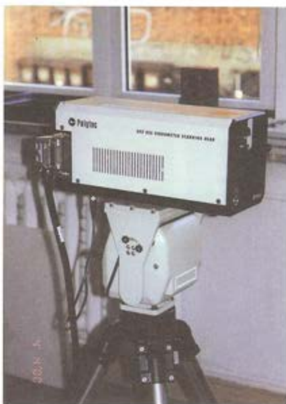
7 | Laservibrometer PSV 300 F, montiert auf Stativ mit motorisiertem Schwenk-Neige-Kopf
